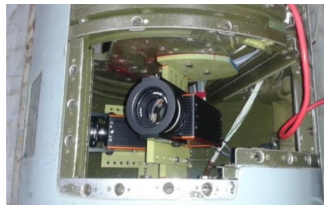
การติดตั้งกล้องภายใน Camera Pod
