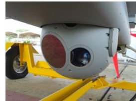
กล้อง LDH ติดตั้งกับ UAV (AERO STAR)
